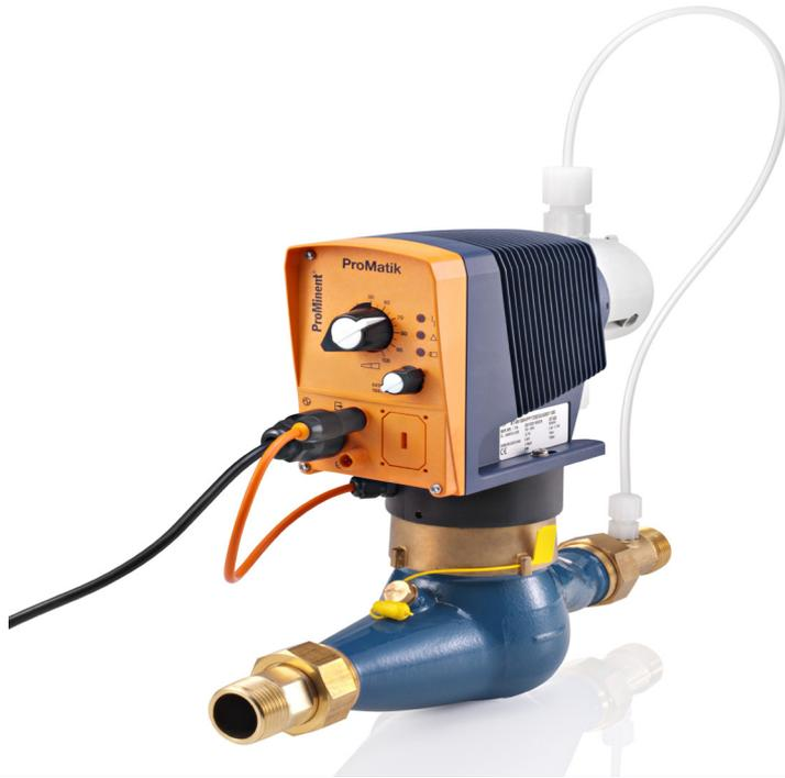
Diese Dosiergeräte schützen Rohrleitungen, Armaturen und Geräte, wie Boiler, Wasch- und Geschirrspülanlagen vor Korrosion und Kalkablagerung. Hier dosiert man Wirkstoffe wie Silikat, Phosphat oder Silikat-Phosphat-Gemische. Diese Wirkstoffe bilden eine Schutzschicht im Leitungsnetz und verringern die Aggressivität und Härteablagerung des Wassers.
